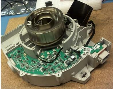
Dispositivo Distribuidor eléctrico de Semillas para Máquinas Sembradoras
