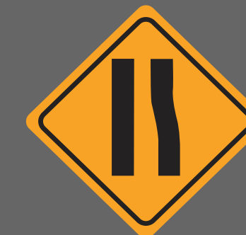
ESTRECHAMIENTO DE CALZADA
