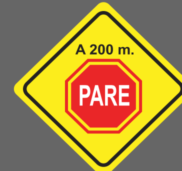
PROXIMIDAD DE SEÑAL RESTRICTIVA (pare)
